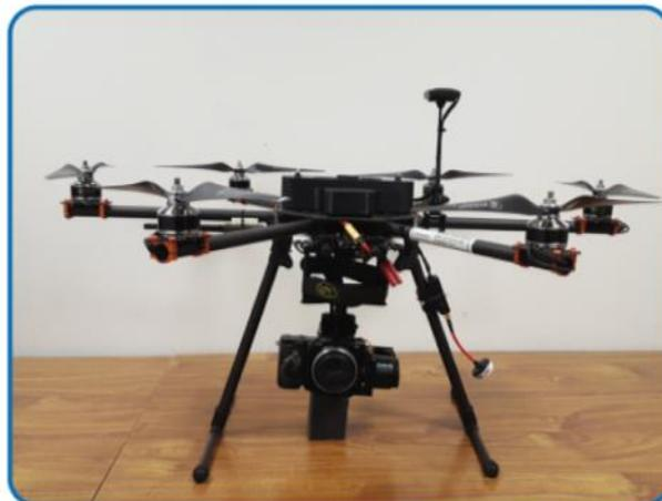
Drone avec capteur Sony Alpha 6000 embarqué
