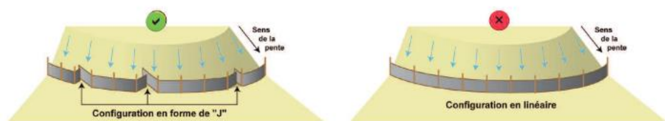
Figure 39. Principes d'installation de barrières de rétention : en série et en « J ». Source : McCullah (2007).
