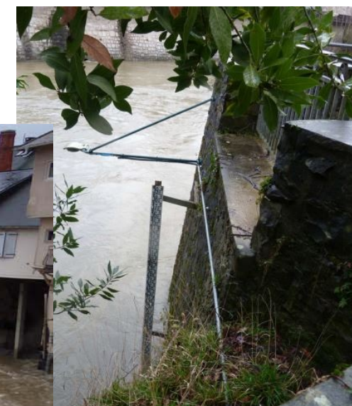
Echelle limnimétrique de Mauléon-Licharre
