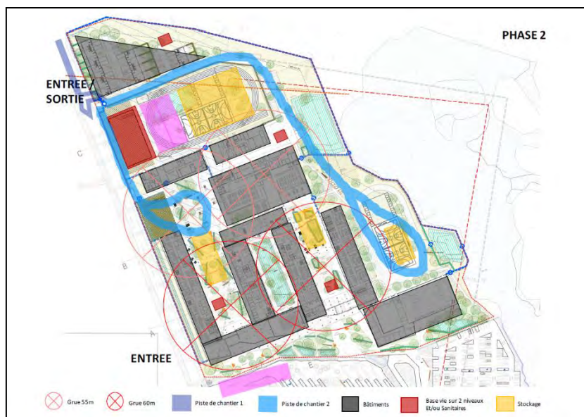
Phase d'installation du chantier - Phase 2
