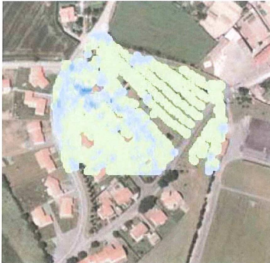
« Les valeurs inférieures à 300 c/s (soit 0,36  $\mu\text{Sv/h}$ ) représentent plus de 98 % de l'ensemble des mesures (1 431 valeurs). 19 mesures sont comprises entre 300 et 450 c/s (0,36 à 0,54  $\mu\text{Sv/h}$ ) et 3 valeurs se situent dans la plage 450 - 600 c/s (0,54 - 0,72  $\mu\text{Sv/h}$ ). La valeur maximale enregistrée est de 521 c/s (soit 0,63  $\mu\text{Sv/h}$ ). »
