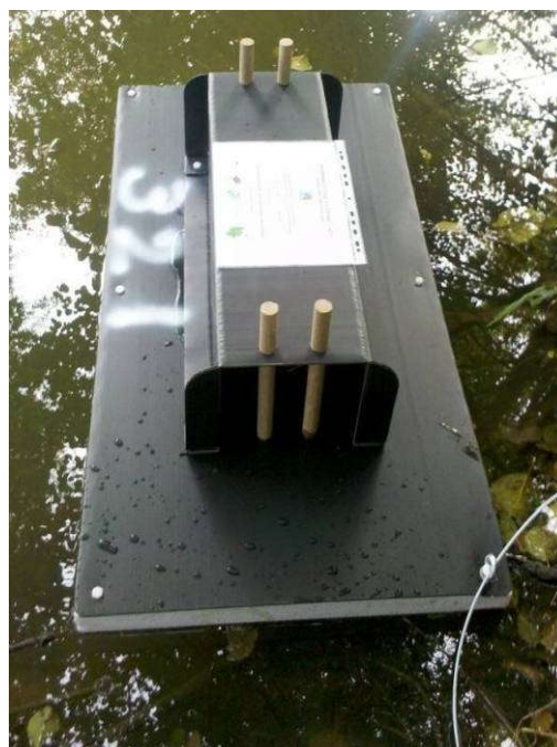
Figure 5 : Exemple d'un radeau à empreintes pour détecter le Vison d'Amérique
