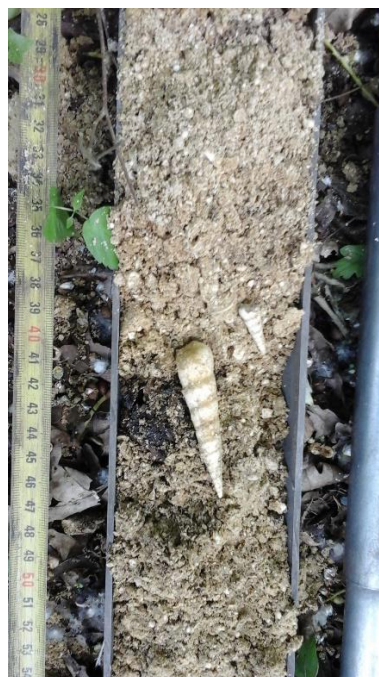
Sol remaniés remblais sable coquiller sur les sondages 31-33
