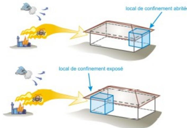
La détermination « exposées » ou « abritées » des façades d'un bâtiment ou d'un local de confinement par rapport au site industriel est faite à partir des sources d'émission des produits toxiques. Ce peut être par exemple un linéaire de canalisations, un point ou l'enveloppe d'une structure. Le caractère « exposé » d'une façade est déterminé selon les principes de la norme NF EN 15242 (*méthode de calcul pour la détermination des débits d'air dans les bâtiments y compris l'infiltration*).
