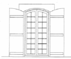
Ce dessin montre la proportion d'une fenêtre avec ses petits carreaux et ses contrevents d'origine
