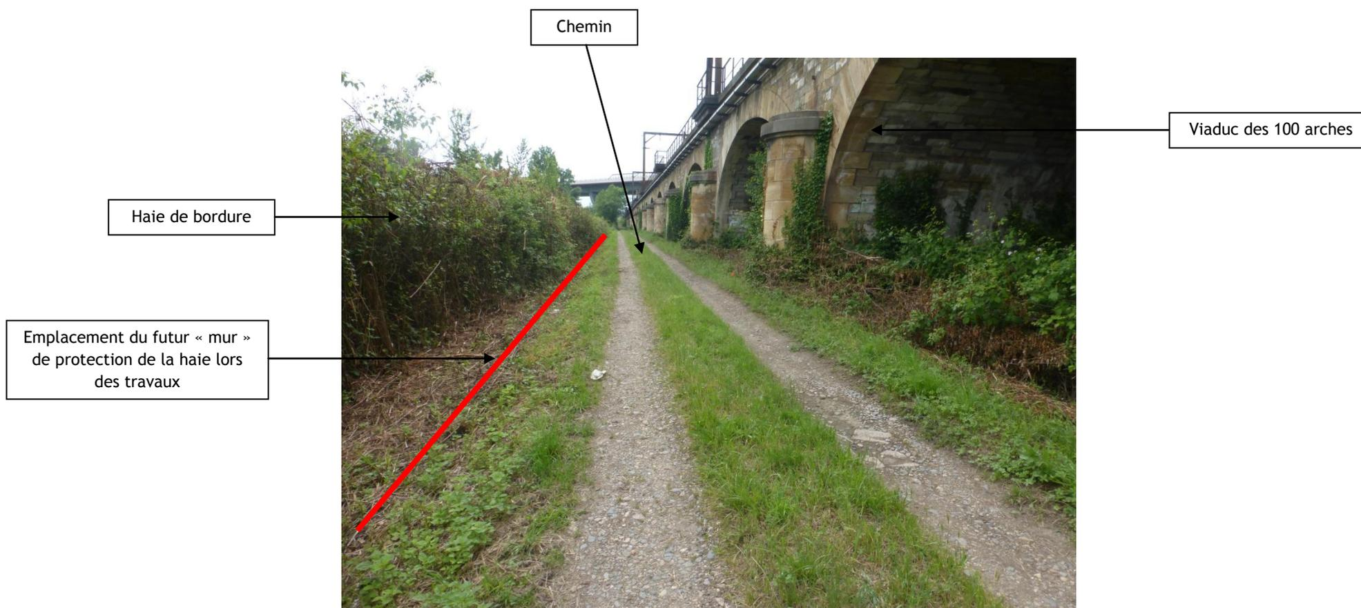
Photo 34 : Localisation de la mise en place du futur « muret » de protection qui sera installé pour les travaux de réfection de la voie
