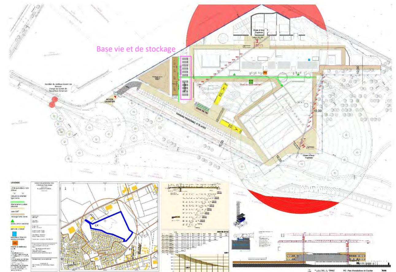
Figure 31 : Plan prévisionnel d'installation de chantier du collège de Beutre
