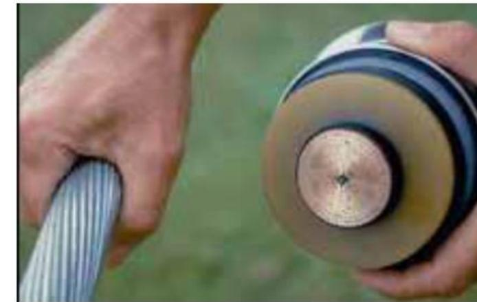
Figure 15: Câble nu aérien à gauche et câble souterrain isolé à droite
