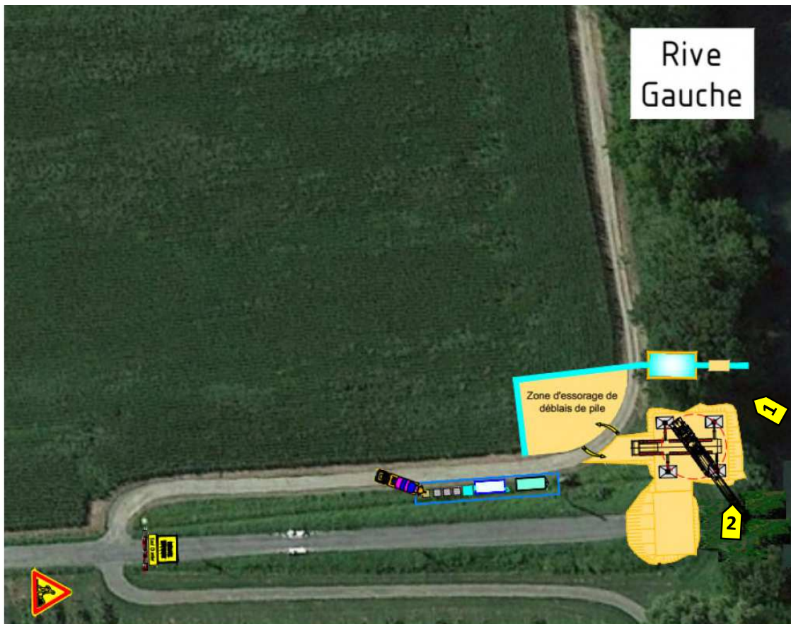
Aménagement des installations de chantier en rive gauche
