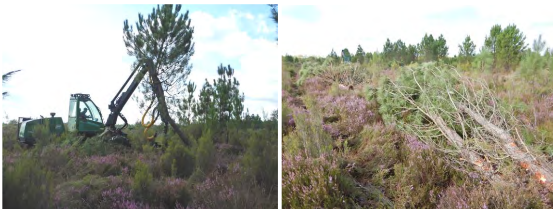
Abatteuse et andain (source : Apave)
