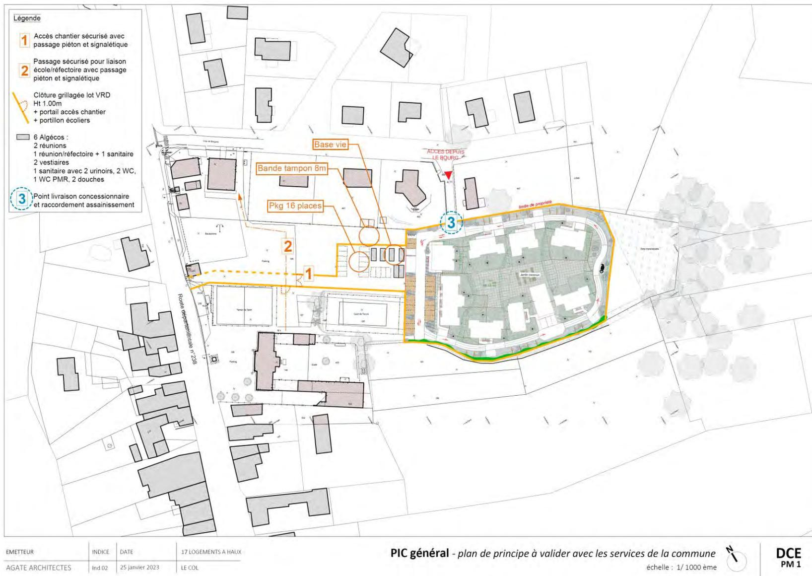
Carte 6 : Plan de principe des aménagements chantier (échelle 1/1000<sup>ème</sup> – Source : Agathe Architectes).
