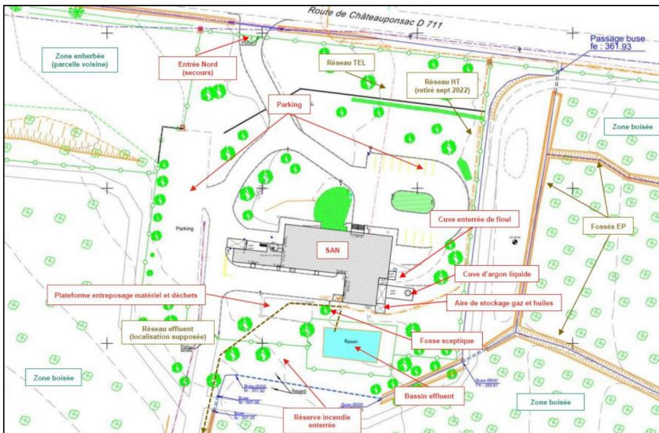
Figure : Description des installations extérieures du SAN, source Orano Mining
