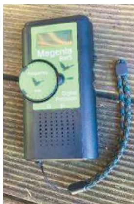
Figure 9 : Enregistreur SM2BAT+ de Peterson (Source : Cabinet JYB & PG-nat)
