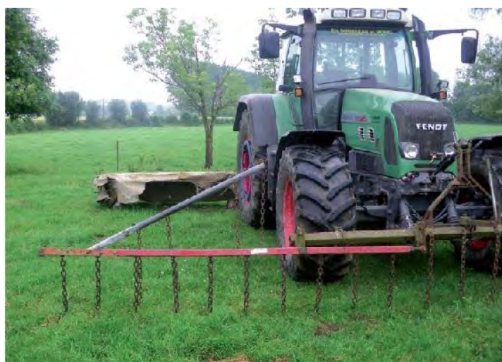
Figure 52 :Barre d’effarouchement implantée sur un engin mécanique - Source ETEN
