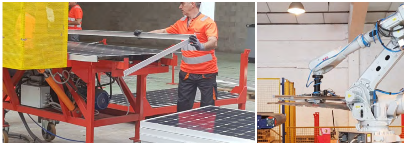
Figure 19 : Décadage des modules et chargement du modules laminés avant découpage, broyage et séparation des éléments
