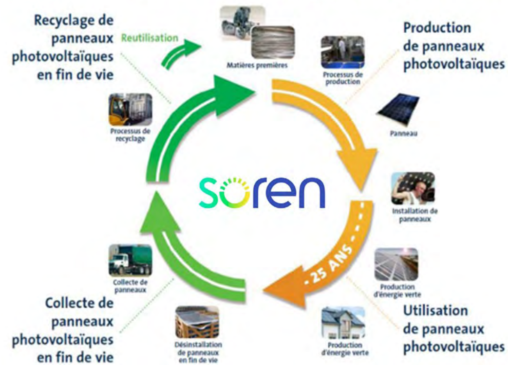
Figure 18 : Schéma du cycle de vie des panneaux photovoltaïques en silicium cristallin
