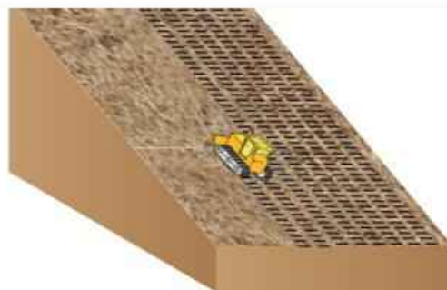
Figure 59 : Exemples de méthode de mise en défens de zones de dépôt (à gauche) et de méthode de chenillage utilisées afin de réduire l'érosion ; Source : Guide technique de l'AFB : Bonnes pratiques environnementales – Protection des milieux aquatiques en phase chantier – Fev. 2018.
