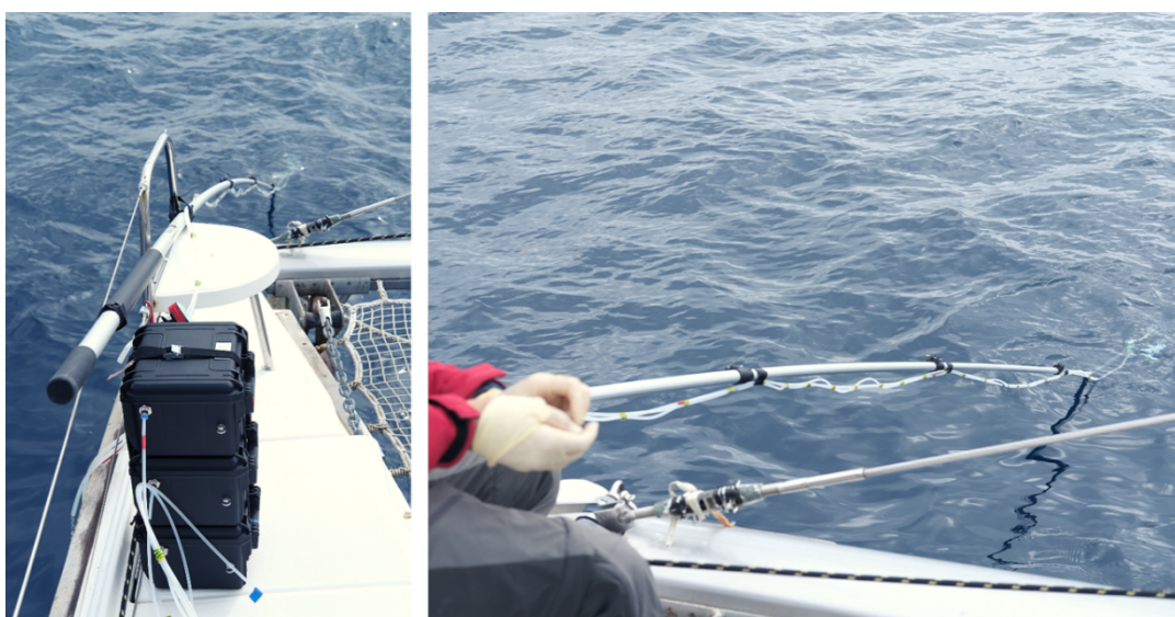
Figure 4. Dispositif de filtration avec système de pompage (à gauche) et perche (à droite) utilisé pour la filtration d'eau de mer à l'avant du bateau.
