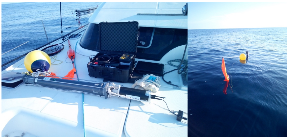
Figure 6. Images du dispositif de déploiement à la dérive et relié à une bouée de surface.
