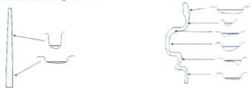
A gauche, profils en travers simplifiés (cours d'eau rectifiés ou artificiels) – A droite, profils en travers diversifiés en conditions naturelles (source ONEMA)
