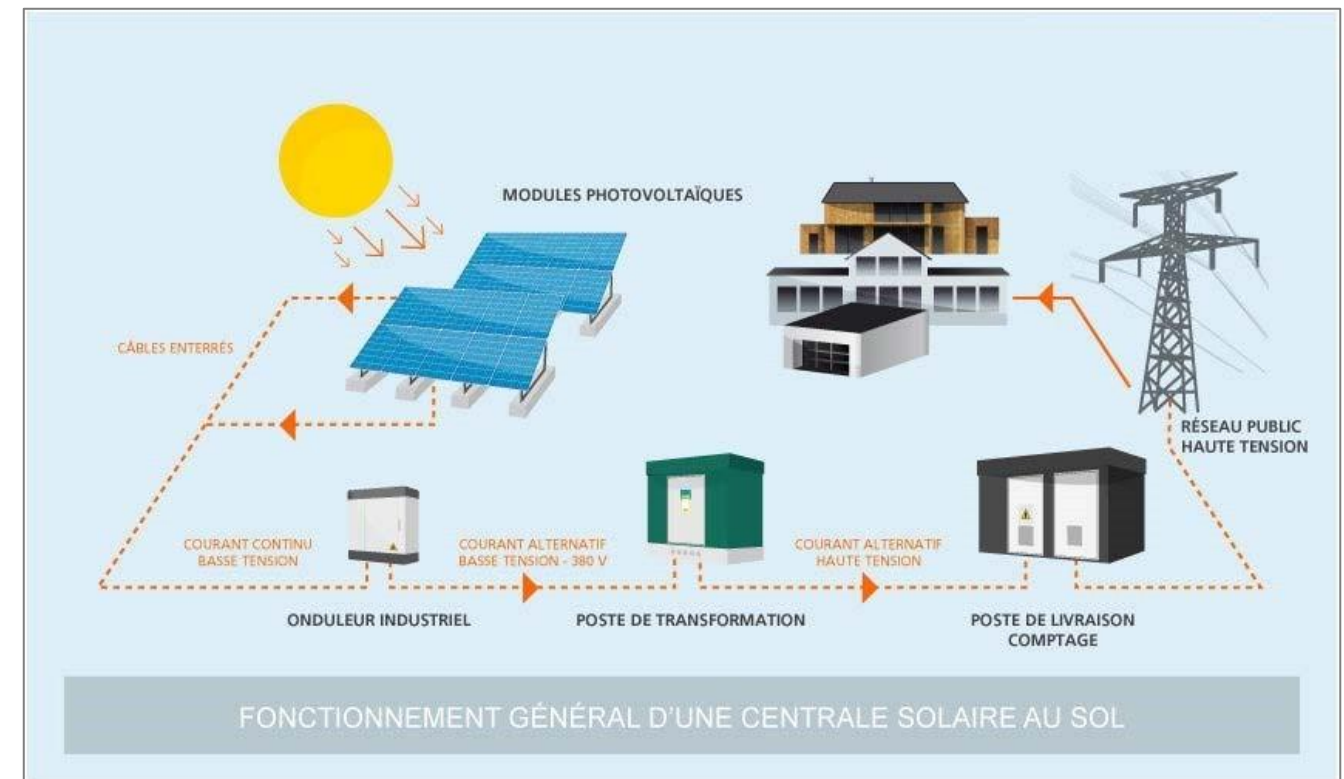
Figure 14 : Schéma de principe du raccordement électrique de la centrale (Source : Entreprise Total)
