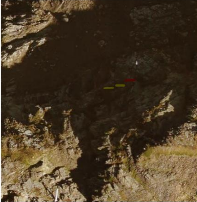
Ouvrages en vert : ligne basse ER 30 implantée en 2021 En rouge : ouvrage ER 30 à rajouter pour compléter le dispositif
