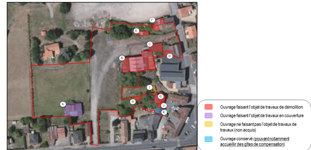
Figure 8 : Projet porté par l'EPFNA – Désamiantage, dépollution, déconstruction,
