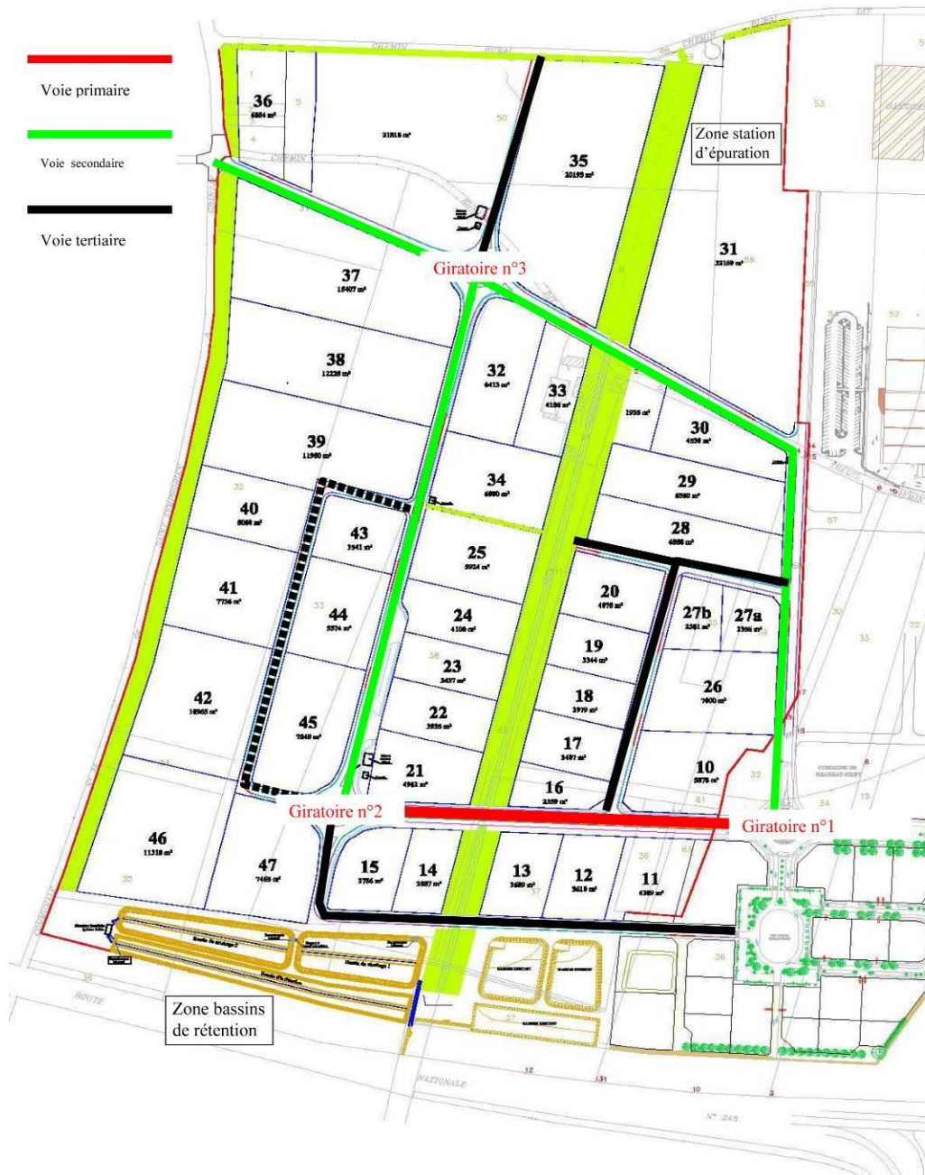
Figure 4 : Organisation des voiries au sein de la ZAC
