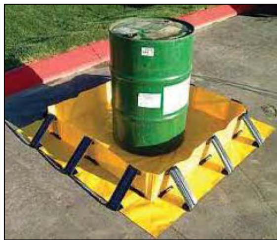
Figure 56 : Stockage de produit dangereux au sein d'un bac étanche (Source : Préfecture du Puy de Dôme)
