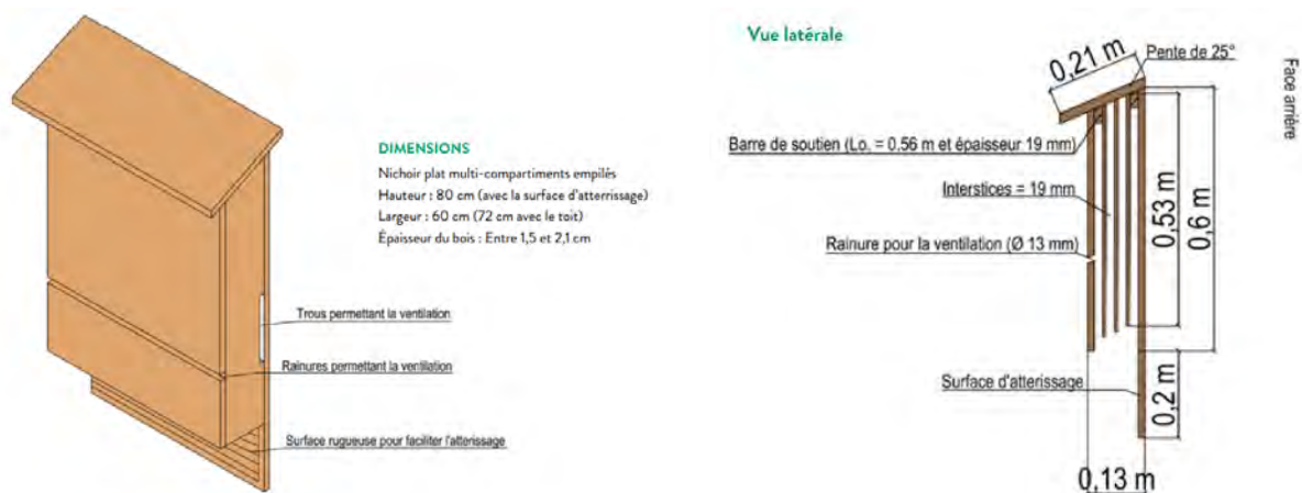
Figure 64 : Nichoir "plat" (Source : ECOTEC, selon plan de Bat Conservation International et CCO-GE)
