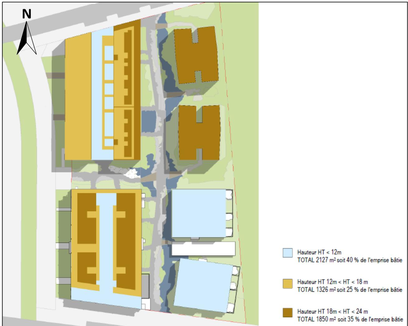
Figure 10 : Plan des variations d'épannelage des bâtiments de l'îlot CA1' (Source : PICHET)
