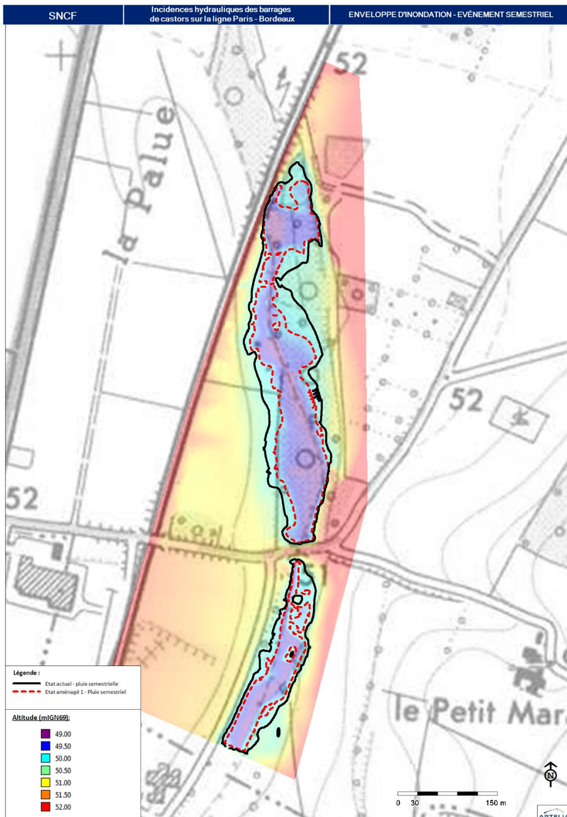
Figure 3. Incidences du projet sur les inondations pour une pluie semestrielle (Source : ARTELIA).
