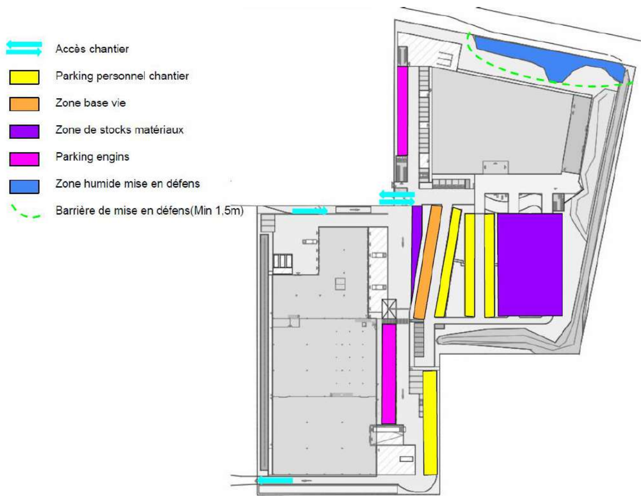
Figure 66 : Plan des installations de chantier au sein des zones à aménager
