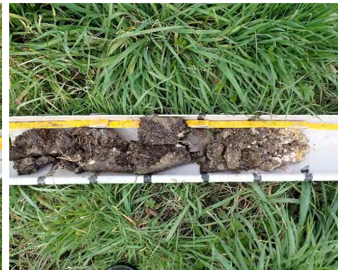
Sondage non humide n° 11- sol remblayé
