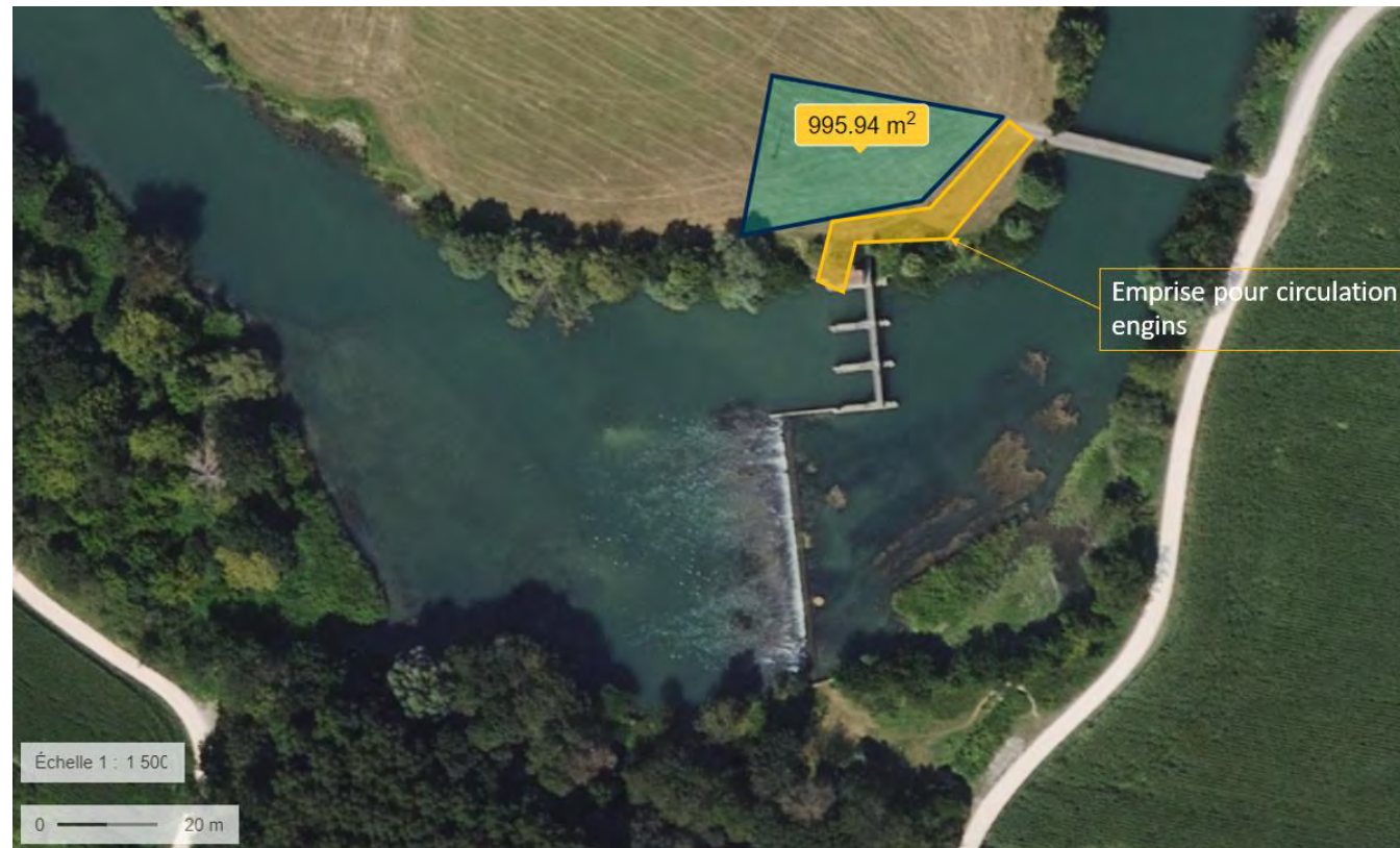
Figure 25 : Zone d'installation de chantier pour la 2 ème phase des travaux
