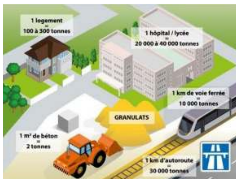
Figure 17 Quantités de granulats nécessaires à la construction d'ouvrages courants
