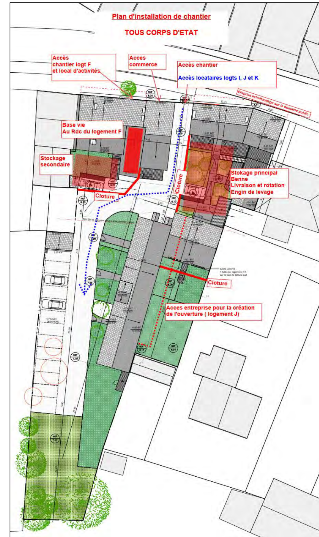
Figure 8 : Plan d'installation général du chantier
