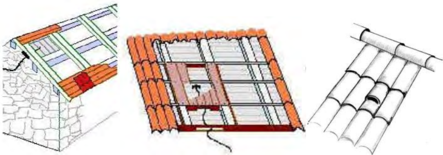
Figure 88 : Exemples d'accès aux toitures (sources : CEN MP, Groupe Chiroptères MP)
