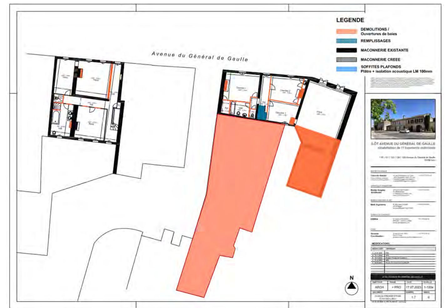
Figure 10 : Plan des travaux à réaliser (étage)
