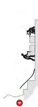
Enfin, le bloc encore humide était immédiatement débité par un tailleur de pierre à l'aide d'une masse et de coins. Outre de la pierre à bâtir, divers objets étaient réalisés : rouleaux à déplier, margelles de puits, auges...
