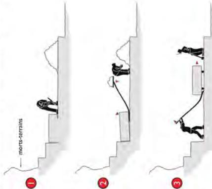
D'abord, le carrier dégageait le banc dont il souhaitait tirer profit. À l'aide d'un pic, il réalisait deux, trois ou quatre saignées verticales pour délimiter un bloc et pratiquait deux encoignures en forme de "v" à sa base.
