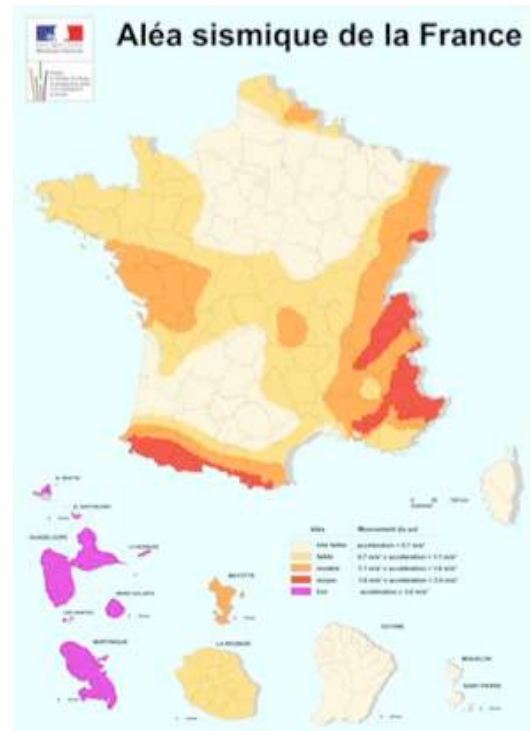
Carte du nouveau zonage sismique EC8 en France métropolitaine et outre-mer. Le mouvement sismique contre lequel se prémunir est donné sous forme d'accélération du sol de référence issue d'une évaluation probabiliste de l'aléa sismique.
