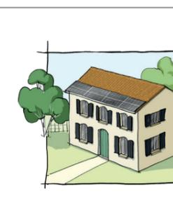
pose sur la largeur de la toiture sur le tiers inférieur
