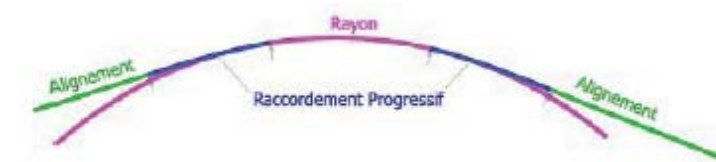
Figure 4 - Eléments géométriques du tracé en plan
