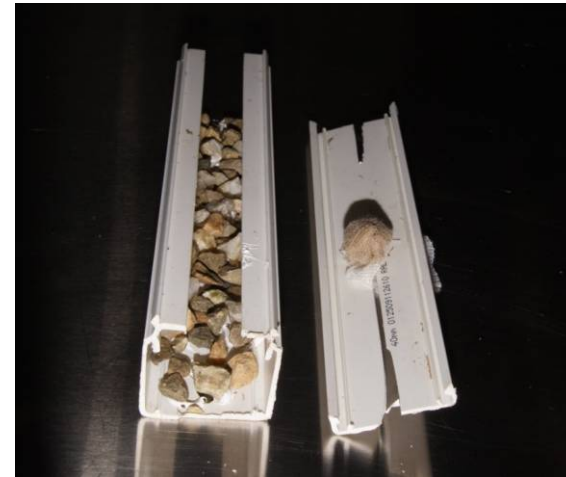
Le fond de la goulotte est muni de cailloux, permettant de « capter » les fèces. Les asticots sont placés dans une compresse glissée dans une fente de la partie supérieure de la goulotte. (Photo : GREGE/C. BOUT).
