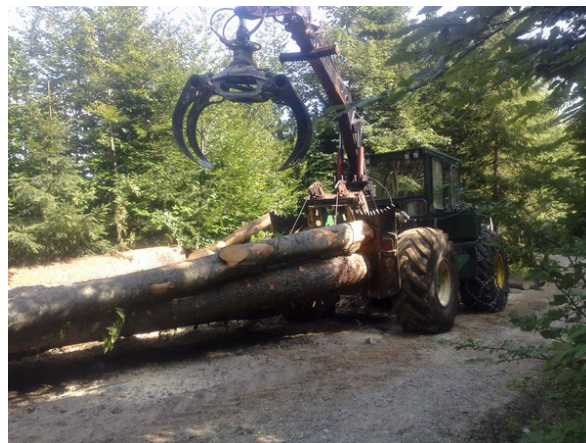
Figure 43 - Illustration du débardage et débusquage
