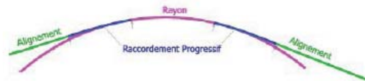
Figure 4 - Eléments géométriques du tracé en plan
