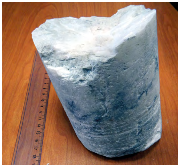
Figure 4 : carotte de gypse albastrôïde extrait de l'horizon des Marnes et Caillasses à partir d'un forage carotté en Ile-de-France, échantillon fourni par le Cerema
