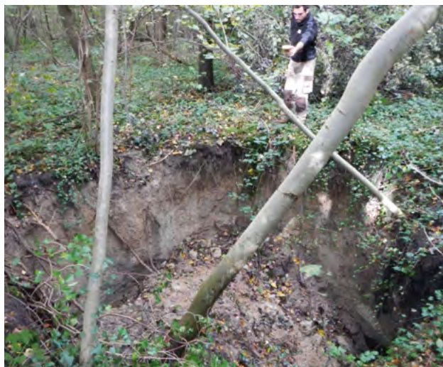
Photographie 1 : fontis de 4 m de diamètre et 2 m de profondeur recensé dans l'enceinte du Bois de la Tussion (Seine-Saint-Denis, 93) en 2013 (Crédit Ineris)
