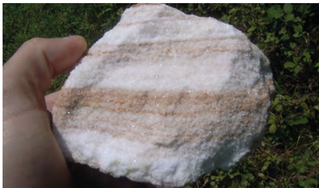
Figure 3 : en haut, bloc de gypse saccharoïde pluri-décimétrique extrait de la carrière souterraine Placoplatre® de Baillet en Ile-de-France. En bas, bloc de gypse saccharoïde décimétrique extrait de la carrière abandonnée de gypse à ciel ouvert à Vizille en Isère (38)
