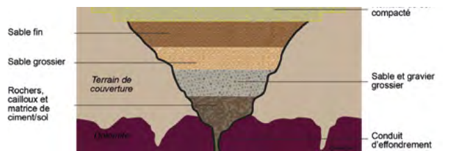
Figure 21 : remblaiement d'un effondrement à l'aide de matériaux granulaires présentant une granulométrie étagée (D'après Waltham et al., 2005)
