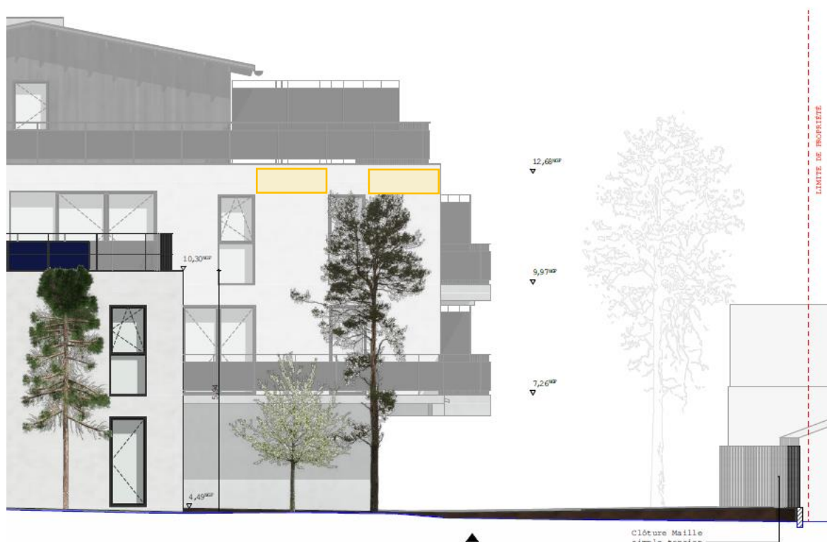
Figure 13: Zone pressentie pour l'intégration de nichoirs artificiels (encadré jaune) en facade sud du bâtiment de logement
