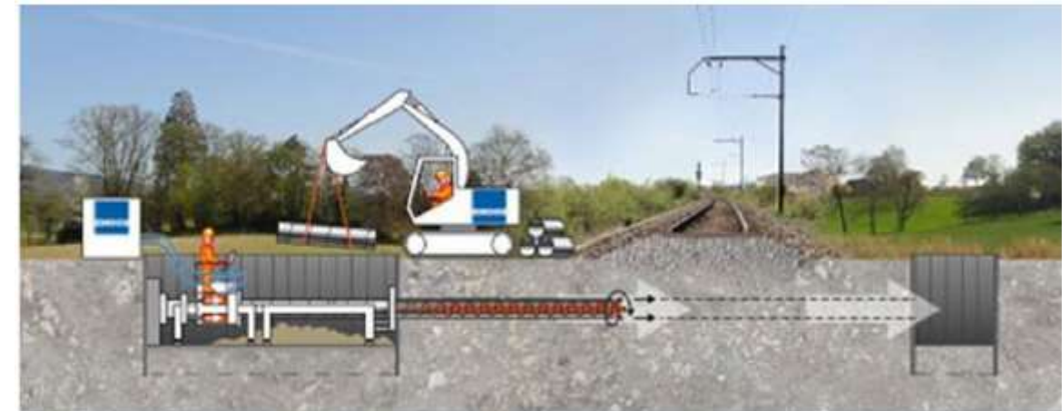
Figure 8 : Schéma de fonçage
