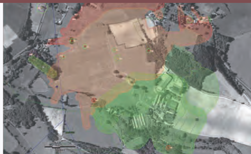
Carte des aléas « effondrement localisé », « tassement » et « glissement » Concessions de Veyrines, La Chapelle-Péchaud, Cladech, Allas-les-Mines et PEX de Dantou
