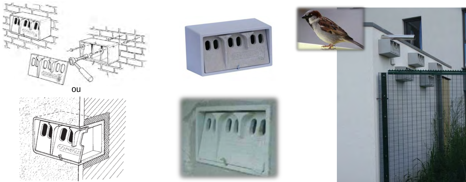
Photo 17 : Illustration de pose de nichoirs à moineau domestique sur un bâtiment
