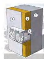
Intégration du nichoirs dans l'ITE de la façade
