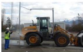
Figure 49 : Nettoyage au jet haute pression d'un engin de chantier Source : www.hp-concept.fr
