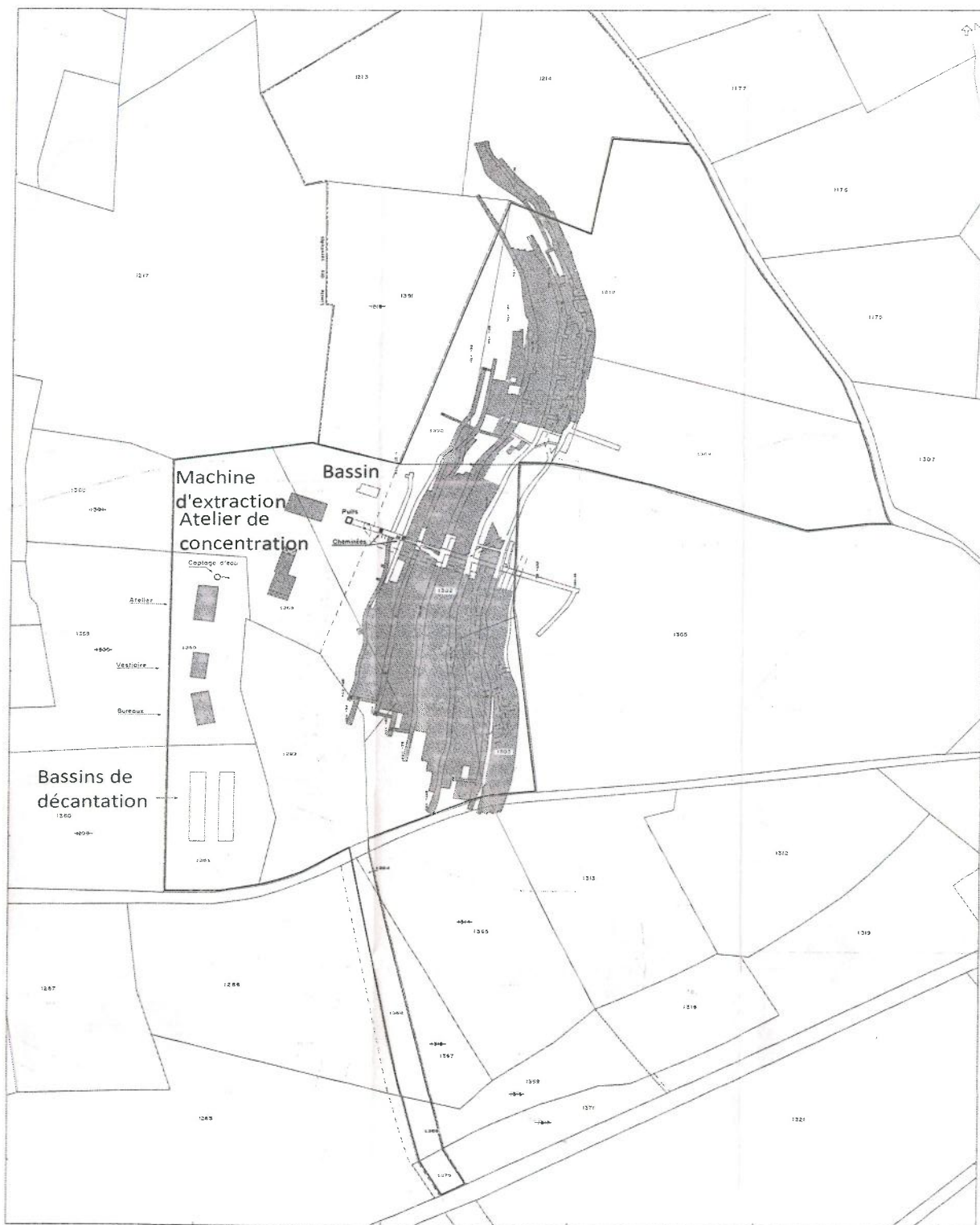
Figure 2 : Plan de superposition des équipements et des travaux miniers avec le relevé cadastral (DADT La Charbonnière)
