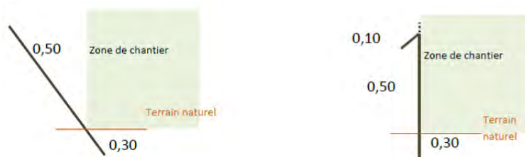
Figure 19 : Principe et caractéristique des clôtures contre l'intrusion des batraciens
