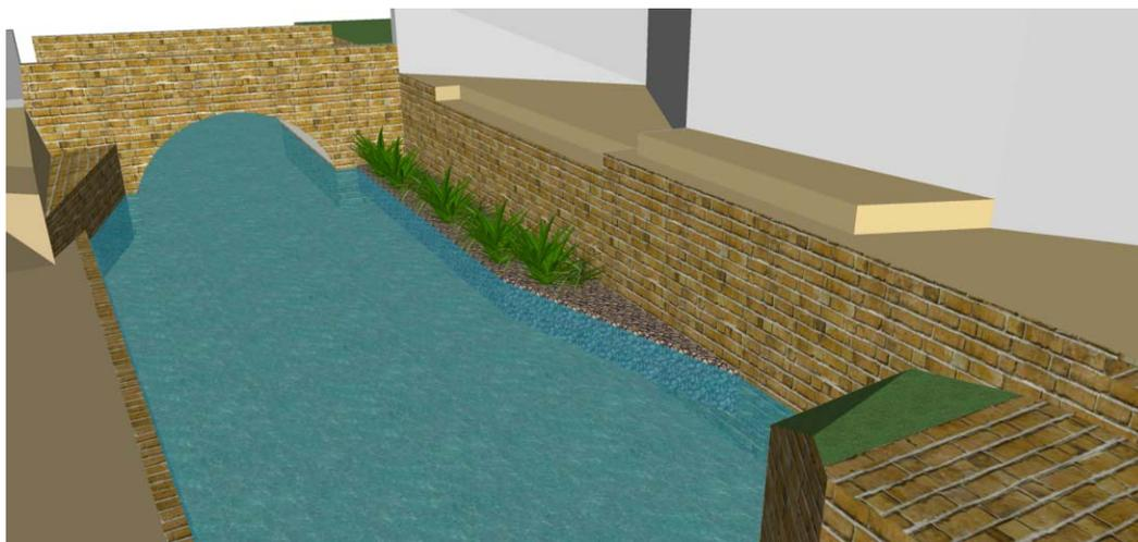
Figure 29 : vue 3D de l'aménagement de berge aval rive droite : gabion végétalisés
