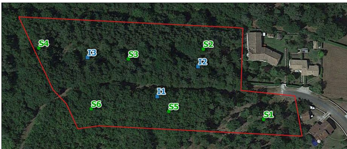
Implantation des sondages pédologiques (S) et des tests de perméabilité (I)
