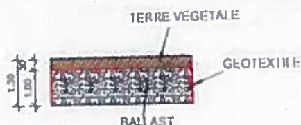
Figure 1: Coupe de principe (à adapter selon étude Loi sur l'Eau) d'un bassin de ré-infiltration naturelle des eaux de pluie
