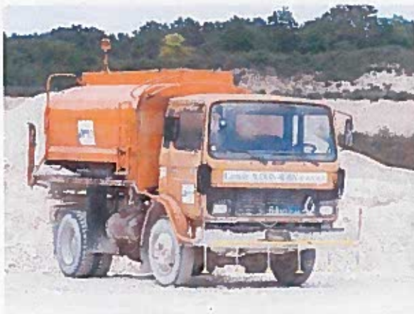
Citerne à eau avec asperseurs
